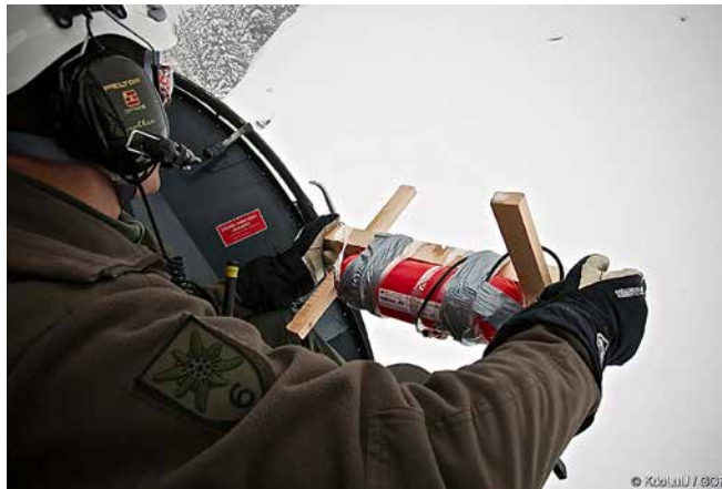
Abwurf einer Sprengladung aus dem Hubschrauber zum künstlichen Auslösen einer Lawine
